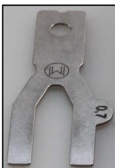
Asportate circa metà del cordone in eccesso ancora caldo con l'apposito coltello Mozart con piastra di distanziamento (0,7mm). Lasciate raffreddare completamente il restante cordone di saldatura e asportate l'eccesso, portandolo in piano con la superficie del pavimento, per mezzo dell'apposito coltello Mozart senza piastra di distanziamento.
