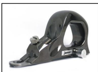
Fresate le giunture della pavimentazione con una profondità di almeno 2,0mm e una larghezza di max. 3,5mm.
