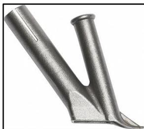
Impostate la saldatrice a 450°C. Per applicare il cordone di saldatura, utilizzate un ugello rapido da 5,0mm.
